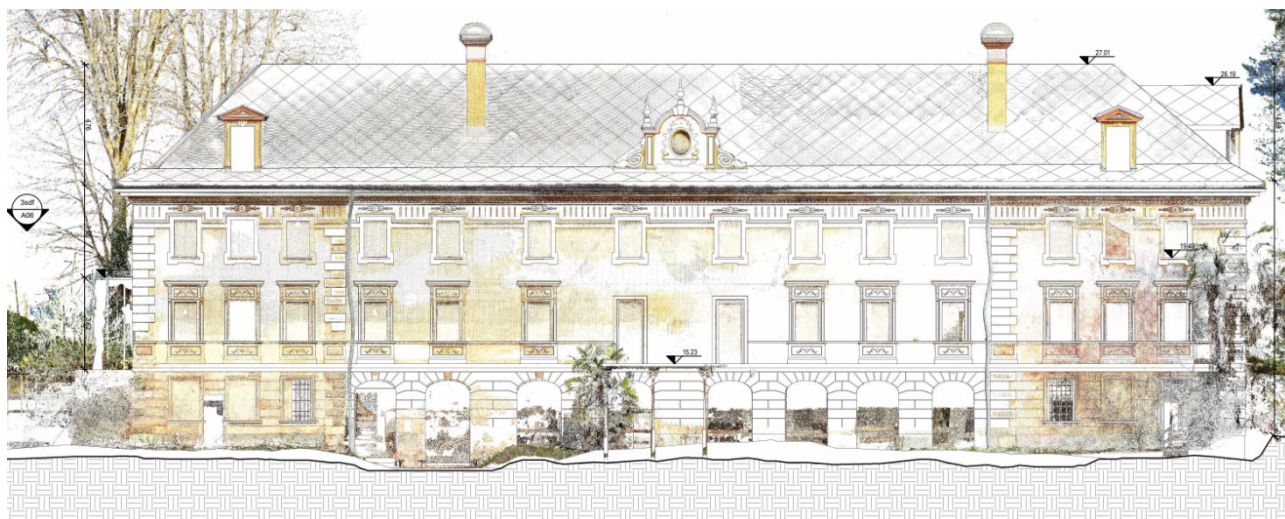
Sovrapposizione tra modello BIM e nuvola di punti: prospetto sud Villa Antica
