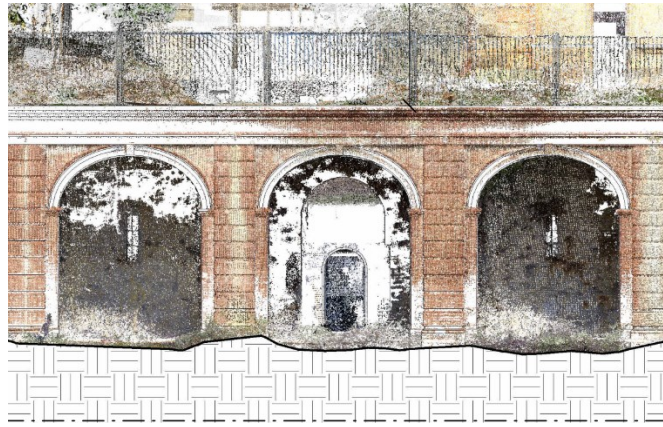
Sovrapposizione tra modello BIM e nuvola di punti: stralcio prospetto Citroniera
