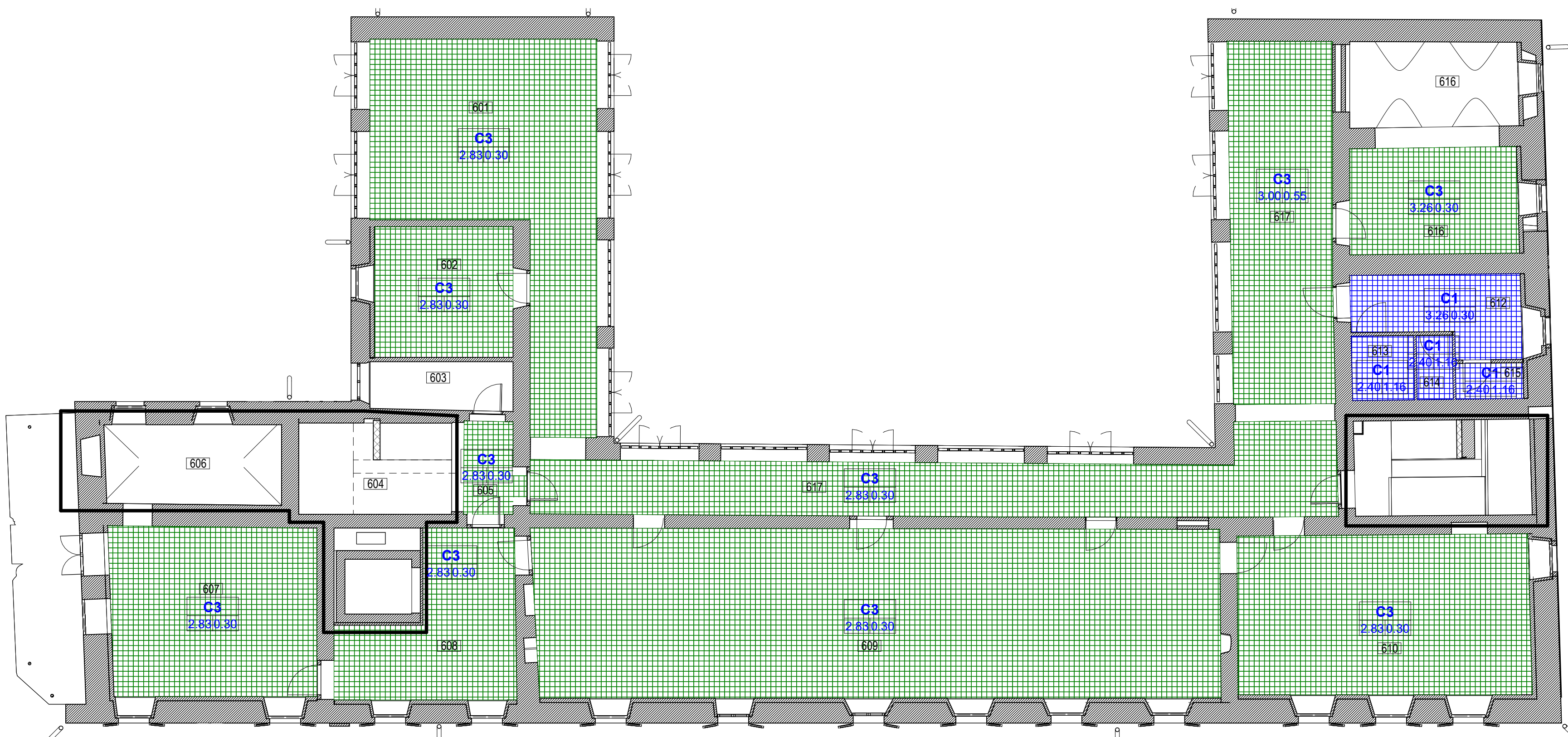
2 Pianta controsoffitti - piano terra - VA 1 : 100
