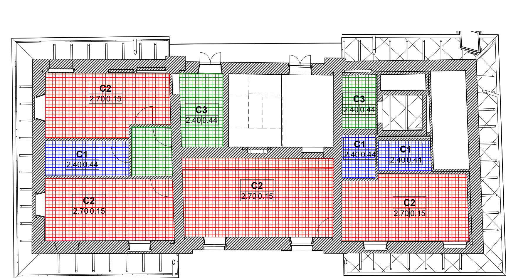
4 Pianta controsoffitti - primo piano - PS 1 : 100
