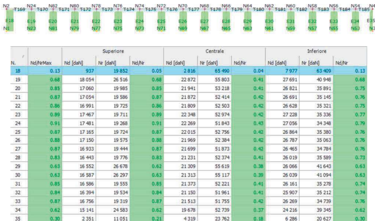
Figura 16 – Dettaglio della parete 1 – verifiche statiche
