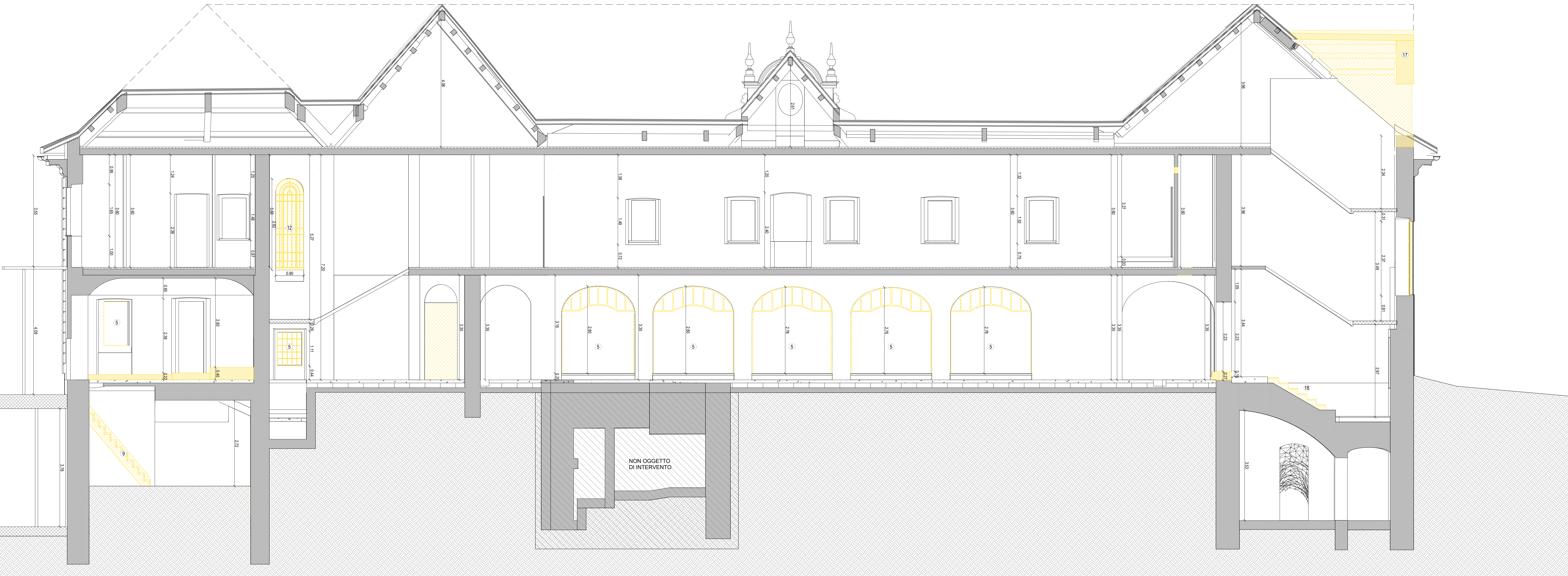
1 sezione MM - demolizioni
