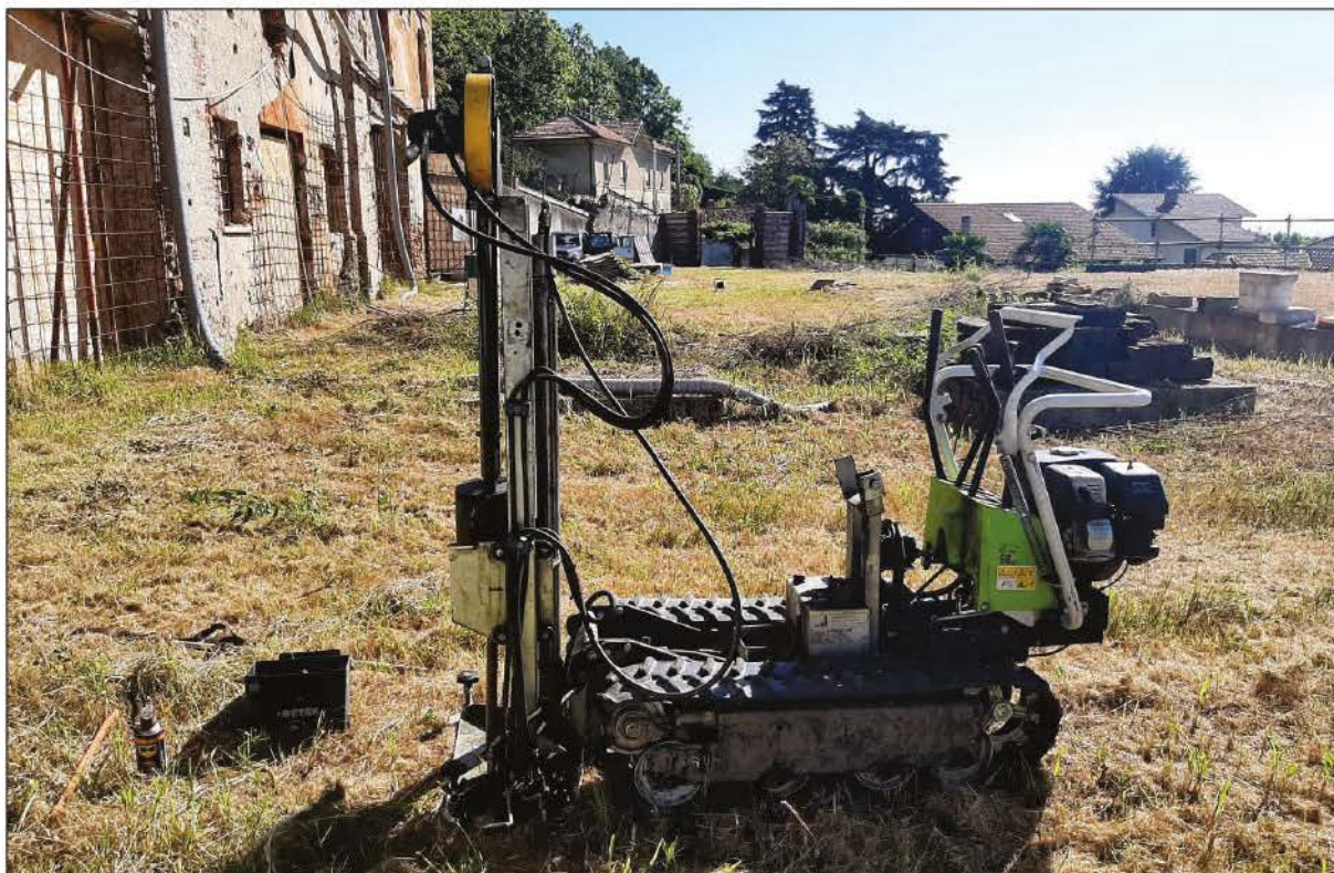
Foto 1: Prova penetrometrica dinamica P1.
