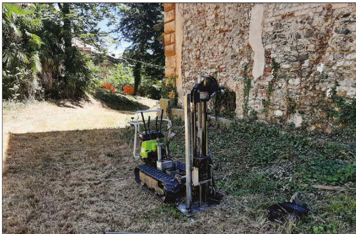
Foto 6: Prova penetrometrica dinamica P6.
