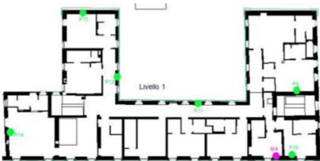
Figura 14 – Indagini sulla muratura Villa Antica – Livello 1
