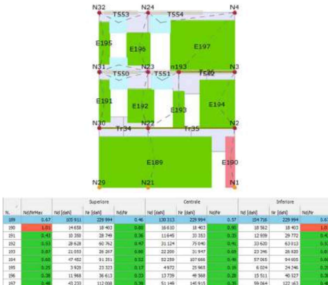
Figura 46 – Dettaglio della parete 6 – verifiche statiche post-intervento
