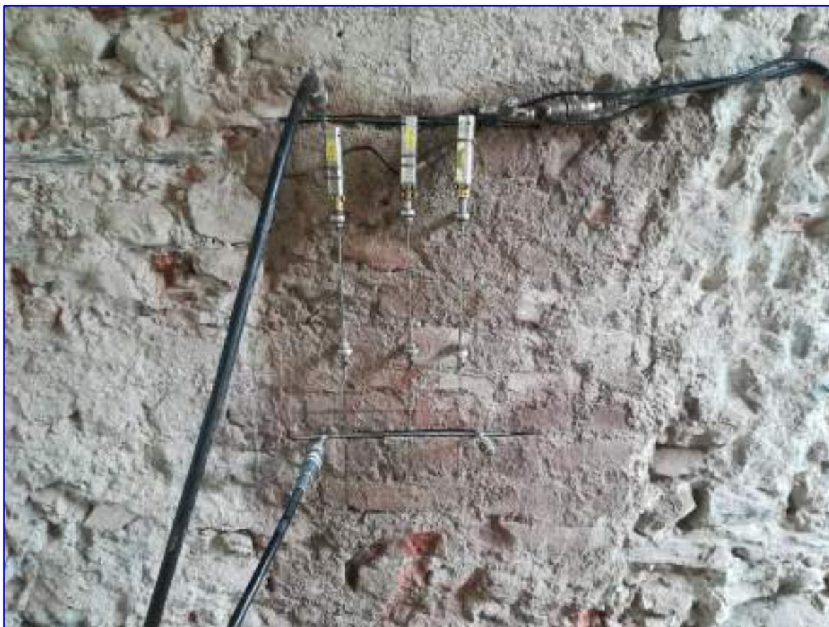
La seconda fase della prova: martinetto piatto doppio
