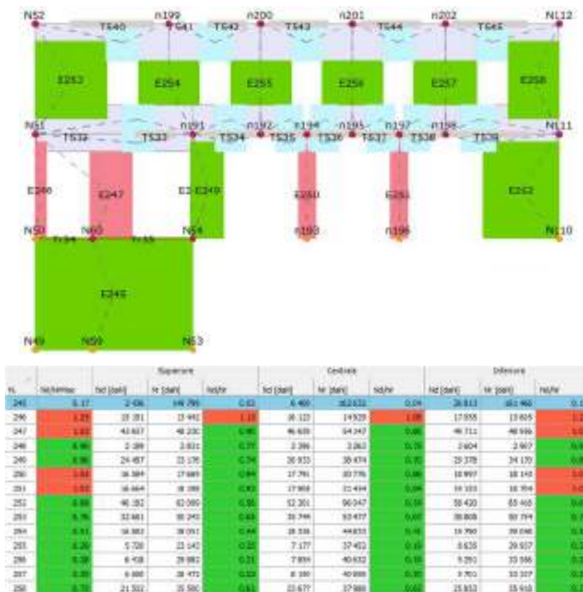
Figura 22 – Dettaglio della parete 10 – verifiche statiche
