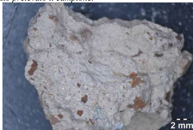
Foto 23: immagine allo stereomicroscopio del campione – Retro
