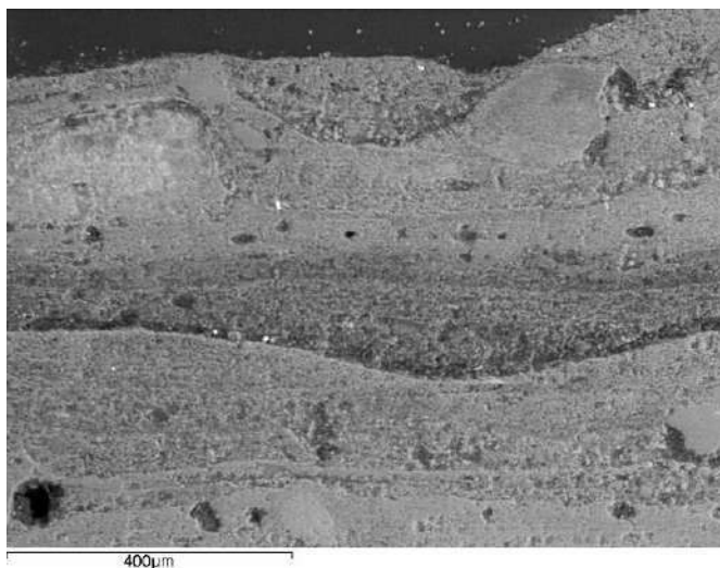
Foto 41: Microfotografia della sezione lucida ottenuta al microscopio elettronico a scansione con elettroni retrodiffusi. Nelle immagini le zone chiare corrispondono a quelle con elementi a maggiore numero atomico.
